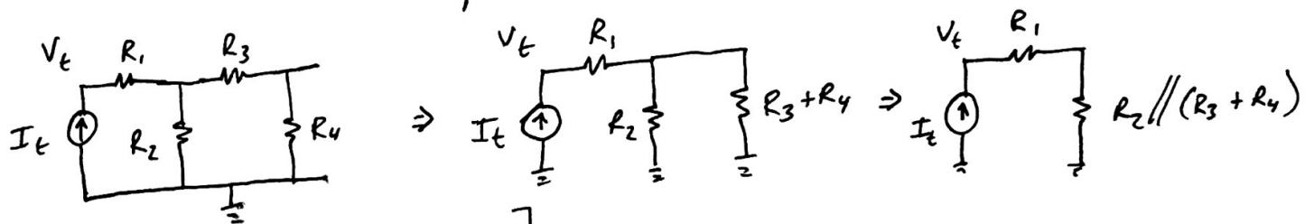
$$V_t = I_t [R_1 + R_2//(R_3+R_4)]$$
