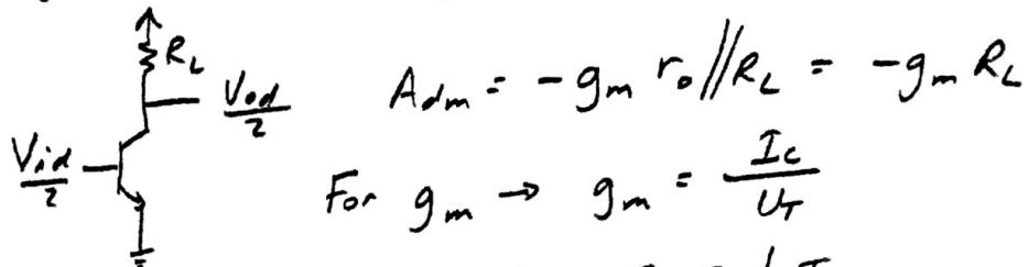
$$A_{dm} = -g_m r_o // R_L = -g_m R_L$$
