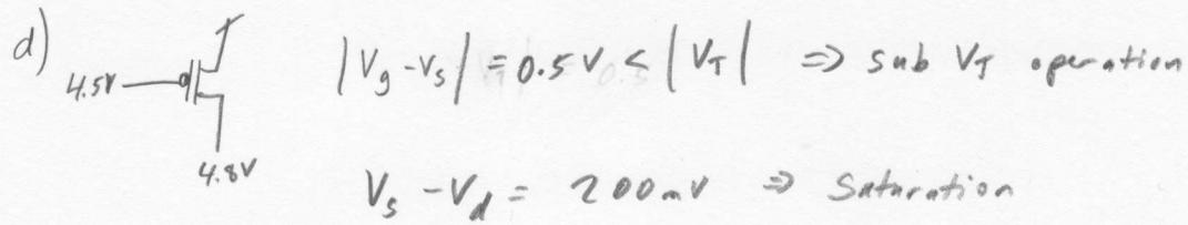
$$I = I_0 e^{\frac{\kappa(V_w - V_g)}{V_T}} e^{-\frac{(V_w - V_s)}{V_T}} e^{\frac{(V_w - V_d)}{V_A}}$$
