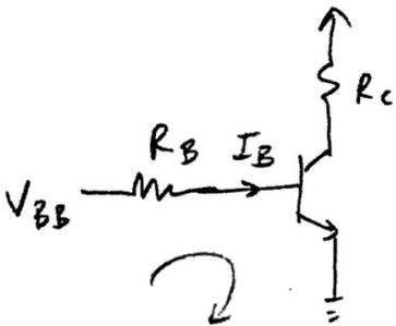
$$\text{KVL} \rightarrow V_{BB} = I_B R_B + V_{BE, on}$$
